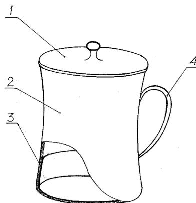
1. 一种麦饭石紫砂保健杯,包括杯盖(1)、杯体(2)、麦饭石薄层(3)、手柄(4),其特征在于以紫砂为原料制成紫砂杯,在紫砂杯杯体内壁下部尚有一层麦饭石薄层,经天然干燥后通过高温煅烧而成。
